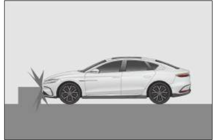
اصطدام مقدمة السيارة بالأرض عند نزول منحدر حاد.
